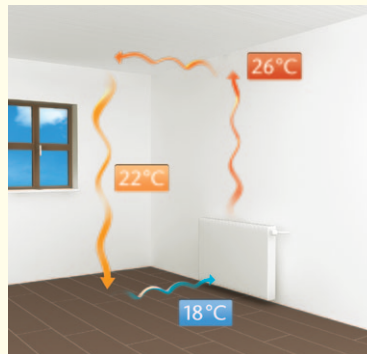
Temperaturverlauf und Thermik bei herkömmlichen Konvektions-Heizsystemen
